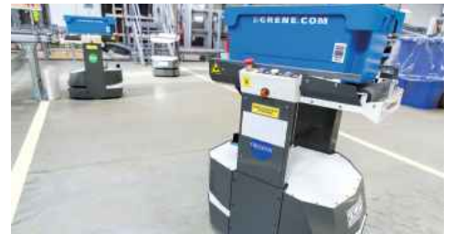
Das Open Shuttle der Grazer Knapp AG fährt völlig autonom.
