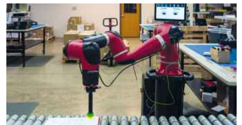
Der von DHL getestete Pickroboter Sawyer kann Artikel bis zu einem Gewicht von 3,8 kg picken.
