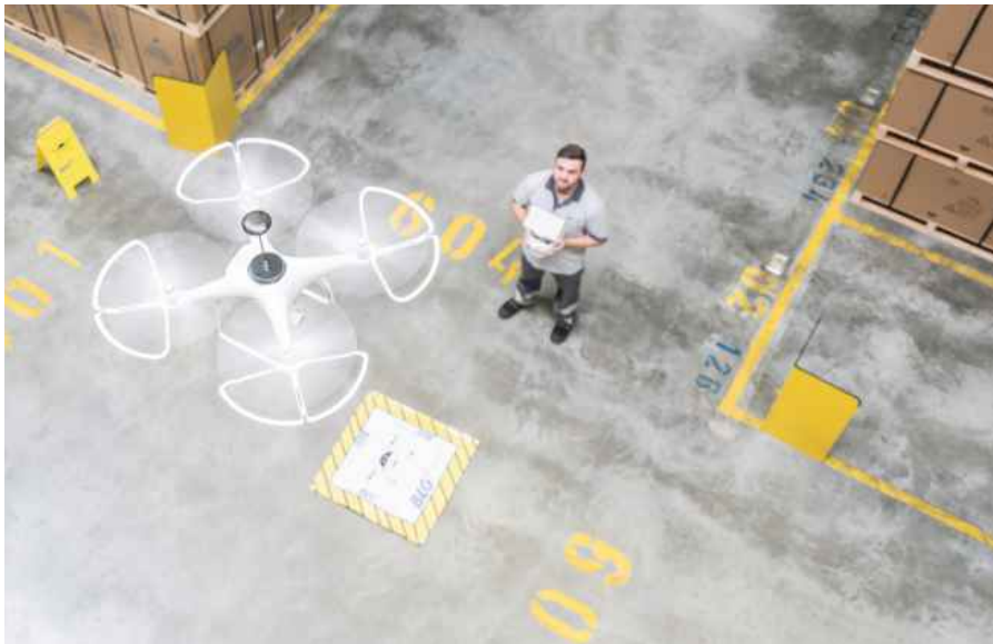
Der Bremer Logistiker BLG testet in Emmerich Drohnen zur Inventur per Barcode-Scan und Kamera.
